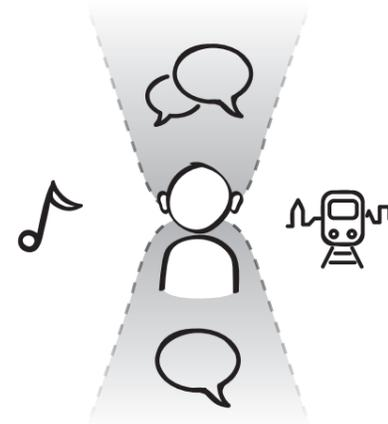
Dieses Feature hebt Sprache hervor und blendet Störgeräusche aus. Durch die spezielle Signalverarbeitung werden Sprachsignale nicht beeinträchtigt und der Klang bleibt natürlich. Hierzu wird innerhalb der einzelnen Bänder das Signal in Störgeräusch und Sprache unterteilt. Danach wird, entsprechend der gewählten Stufe der Störgeräuschfunktion, das Störgeräusch reduziert. Anschließend wird beides wieder zu einem Signal zusammengefügt.
