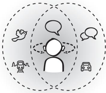
Die Technologie der Binauralen Direktionalität nutzt den Ear-to-Ear-Datenaustausch für die optimale Auswahl des Mikrofonmodus. Es lokalisiert das Sprachsignal und stellt sicher, dass dies klar und verständlich ist - sie geht aber nicht davon aus, dass automatisch das Sprachsignal von Interesse ist. Stattdessen arbeiten beide Hörsysteme zusammen, um ein optimales Direktionalitätsmuster zu wählen, welches weiterhin die Möglichkeit bietet, die Umgebung und andere Sprecher wahrnehmen zu können.
