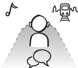
Die Direktionalität mit Sprachfokus ist eine automatische Form, in dem sich der Öffnungswinkel in Abhängigkeit von der Stärke des Hintergrundlärms und der Richtung, aus der das Sprachsignal kommt, verändert.
